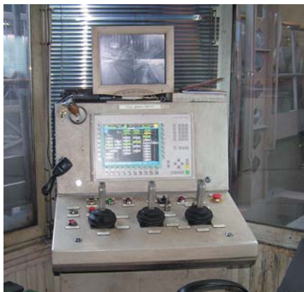
■ Stanowisko pracy operatora wypycharki
